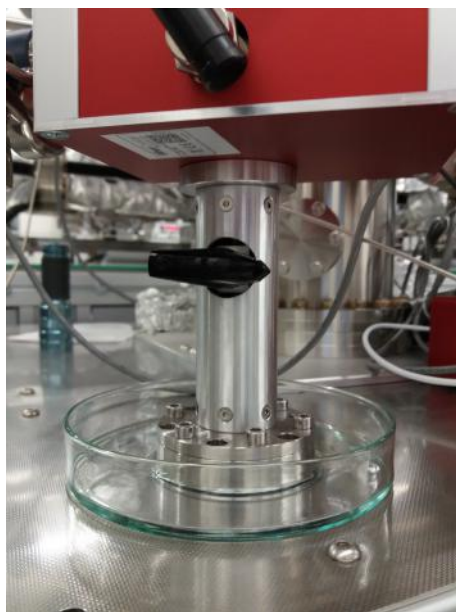
Obrázek 3.3: Ex-situ čištění příruby s pulsním ventilem.
