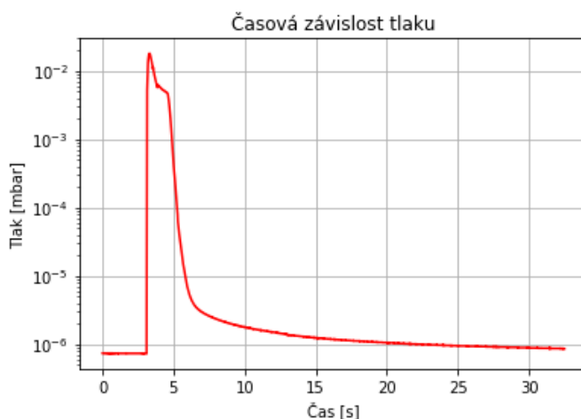
Obrázek 3.17: Graf s píkem tlaku při vstřikování roztoku s molekulou DM18N v dichlormetanu o koncentraci 1 mM.
