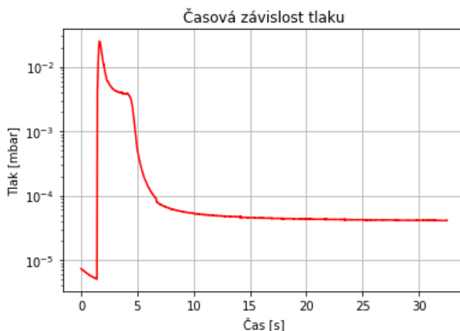
Obrázek 3.22: Graf s píkem tlaku při vstřikování roztoku s molekulou \text{Cu}(\text{dbm})_2 v dimethylformamidu o koncentraci 1 mM.
